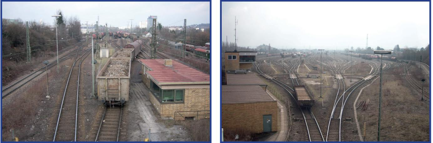
*Abb: Im Rangierbahnhof Kornwestheim, dem zentralen Rangierbahnhof für den Einzelwagenverkehr in Württemberg, werden die Waggons der ankommenden Züge über den Buckel („Ablaufberg“) gedrückt (links) und rollen dann aus eigener Kraft in die Gleise, in denen die Waggons nach Destinationen zu abgehenden Zügen zusammengefasst werden (links). Fotos: Junmin Wu.*
